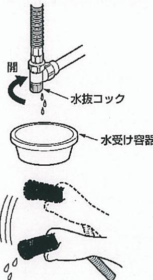
4. 水抜コックの下に水受け容器(洗面器など)を用意し、水抜コックを開ける。
