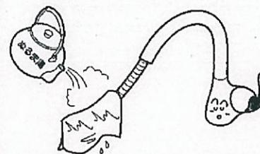
水抜きを行っても吐水口の網目に付着した水滴が凍り、通水後も少しの間、水が出ない場合があります。
