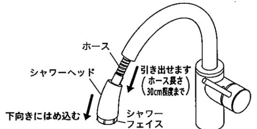
**【注意】** シャワーヘッドを引き出しすぎないでください。ホースが戻しにくくなったり、ホース損傷により漏水で家財などを濡らす財産損害発生のおそれがあります。
