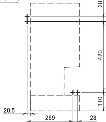
② 温水器固定用ビス(付属品、2本)を使用し、置台と壁固定金具を固定します。
