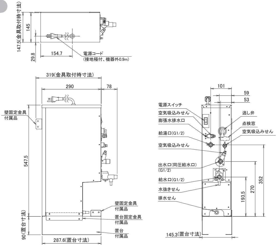
※本図は、代表例として、右向きに設置した場合の壁固定金具、置台固定金具、置台取付時の外形図を記載しています。左向きに設置する場合、対称の寸法となります。
