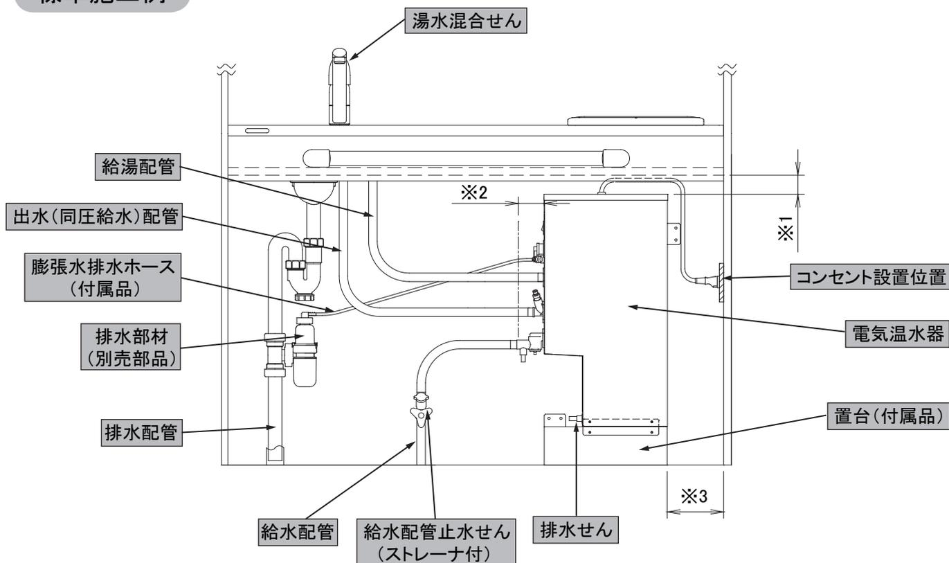
※1：45mm以上確保してください(温水器取り付けや、電源コードの引き回し等に必要な寸法です。)
