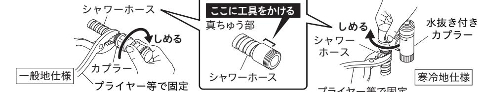
② カプラーのキャップをはずし、スライダーを下に下ろしてからプラグヘカチッと音がするまでね込みます。（寒冷地仕様の場合はエルボが下向きになっていることを確認します。）
