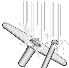
⑤回転ノズル・タワーノズルを取り付けます。
