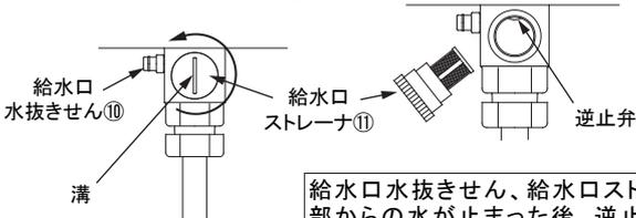
給水口ストレーナ⑪はコインなどを溝に差し入れ左に回して取りはずします。
