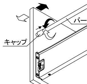
上下・左右調整する場合は、底板下部の金具を止めているネジを緩めてから行う。
