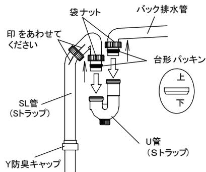
ご注意: ・Y 防臭キャップは、VP40、VU40、VP50、VU50 の 4 種類の排水管に接続できます。
