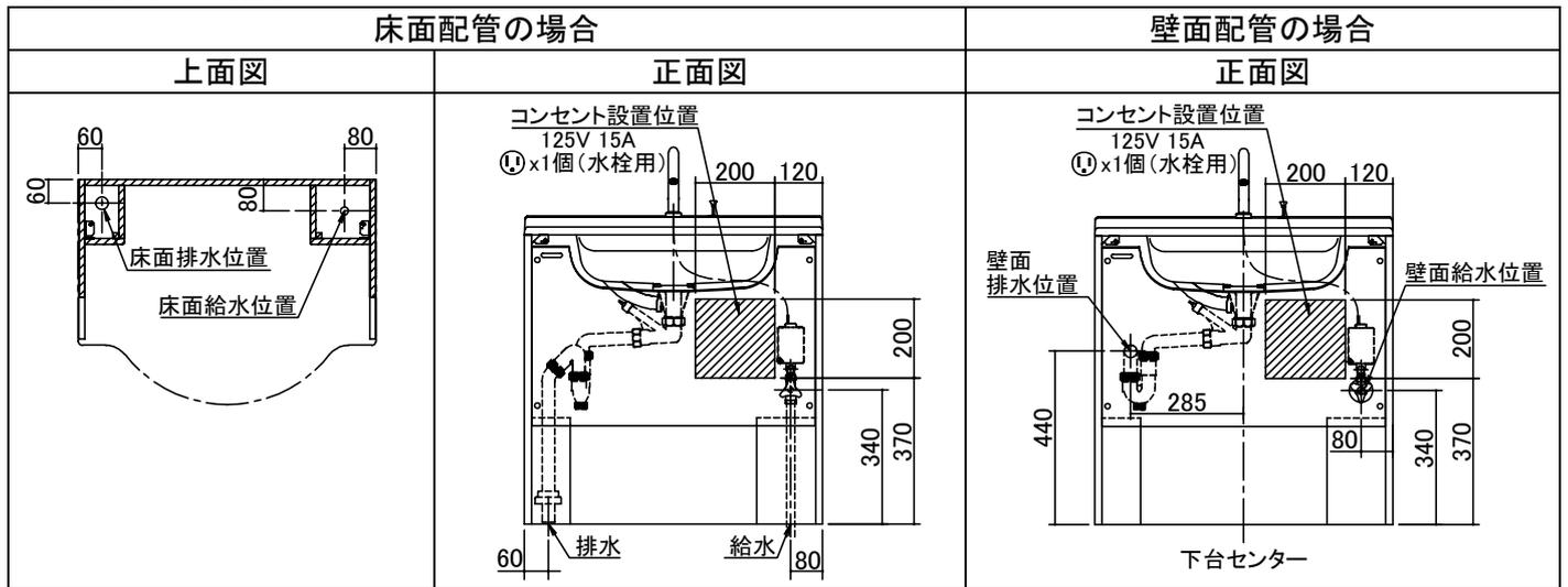
●1穴混合水栓(電気温水器有)の場合
