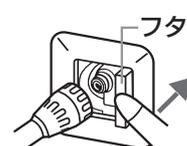
ガスコンセントは、ガスコードなどを取り付けると自動的に開栓し、取り外すと自動的に閉栓します。
