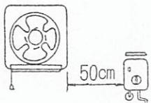
モータ焼損、排ガスによる塗装面のサビ発生の原因となります。
