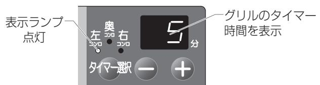
\*最後の操作から5秒後に、表示ランプが点灯に変わり、表示部はグリルのタイマー表示へ切り替わります。
