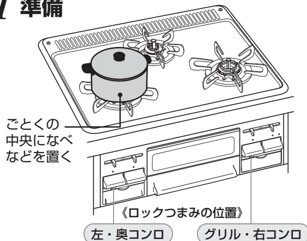
①操作ボタンが押されていないことを確かめて、ガス栓を全開にする
