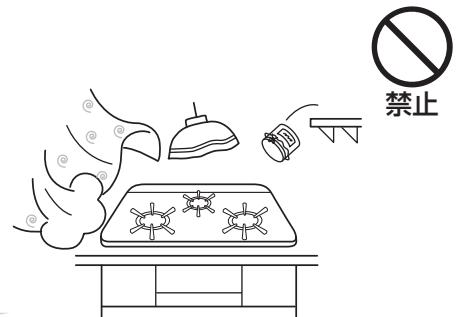
**周囲に可燃物**（木製などの可燃性の壁、ステンレス板や薄いタイルなどの不燃材を可燃性の壁に直接貼り付けた壁、たななど）**のある場合**
