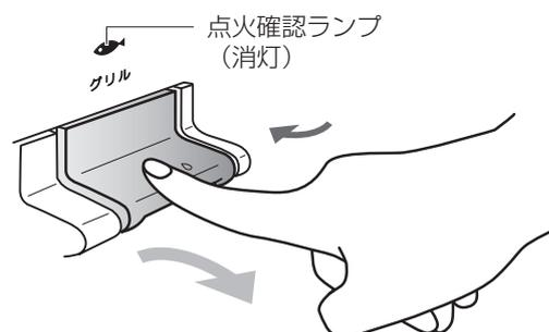
①自動消火後、操作ボタンを押して戻し、消火操作をする
