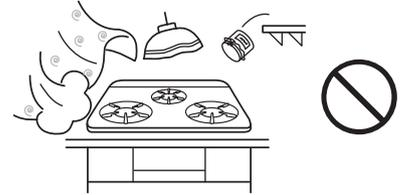
**周囲に可燃物**（木製などの可燃性の壁、ステンレス板や薄いタイルなどの不燃材を可燃性の壁に直接貼り付けた壁、たななど）**のある場合**
