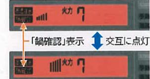
●約30秒後にブザーが鳴り、表示が消え、自動的に通電を停止します。
