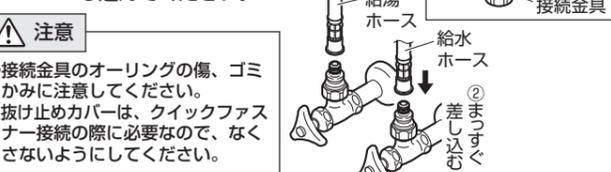
(2) クイックファスナーを給水・給湯ホースと接続金具のツバ部に確実にめ込んでください。次に抜け止めカバーをクイックファスナーに確実にめ込んでください。
