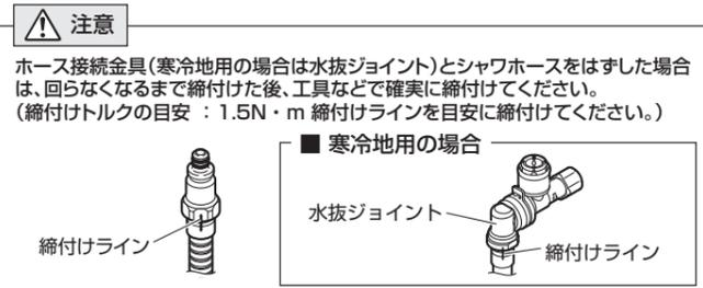
(1) ホース接続金具（寒冷地用は接続金具）の抜け止めカバーとクイックファスナーをはずし、シャワ側接続部にホース接続金具（寒冷地用は接続金具）をツバ部のすき間がなくなるまで差し込んでください。
