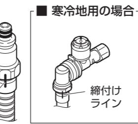
(2) クイックファスナーをシャワ側接続部とホース接続金具（寒冷地用は接続金具）の接続部（ツバ部）に力ちっと音がするまで、確実にはめ込んでください。次に抜け止めカバーをクイックファスナーに確実にはめ込んでください。
