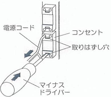
ご注意：・電源コードを引き抜く際、電源コード以外の配線が一緒に抜けないようにご注意ください。
