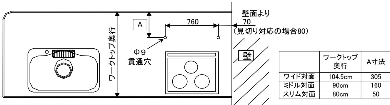
②オイルガードを所定の位置に設置し、リビング側のワークトップ裏面より付属のボルトで固定してください。
