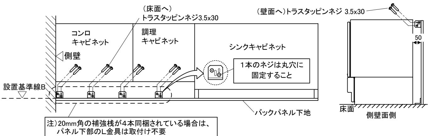
※深型の調理・コンロキャビネットの場合は、キャビネットの連結ボルト/ビスを一旦はずし、キャビネットを前に移動させて作業スペースを確保してください。(20mm角の補強桿が4本同梱されている場合は移動不要)
