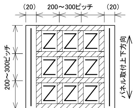
⑥バックパネル下地表面のほこり等をふき取り、④で貼付した両面テープの離型紙をはがし、下図を参照してパネルをバックパネル下地に貼付けてください。
