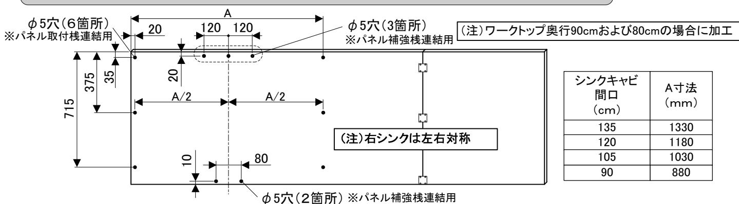
注)20mm角の補強桿が4本同梱されている場合は、6頁【5】の補強桿の位置に合わせてパネル下部に $\phi 5$ 穴を追加してください。(計6箇所)
