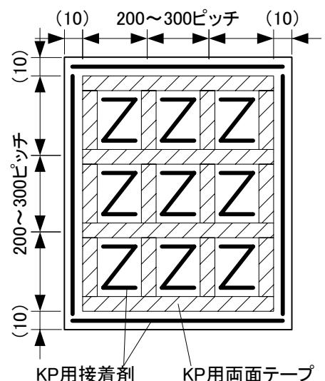
⑤バックパネル下地表面のほこり等をふき取り、③で貼付した両面テープの離型紙をはがし、下図を参照してパネルをバックパネル下地に貼付けてください。
