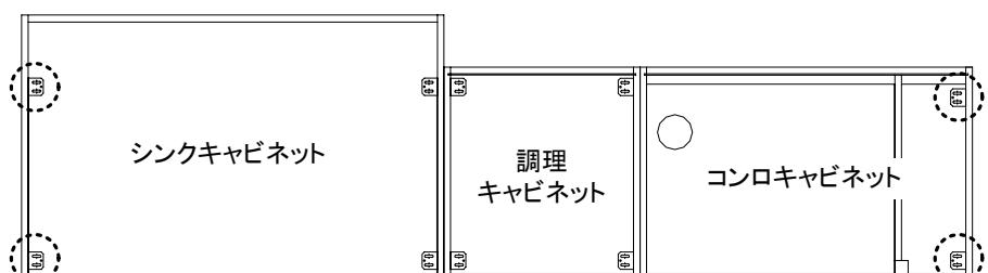
⑤食洗機に隣接するキャビネットの側板上面所定の位置にクッションテープを貼り付けてください。
