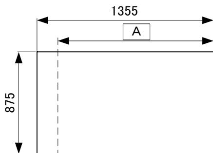
2枚のバックパネルを下記の寸法にカットしてください。
