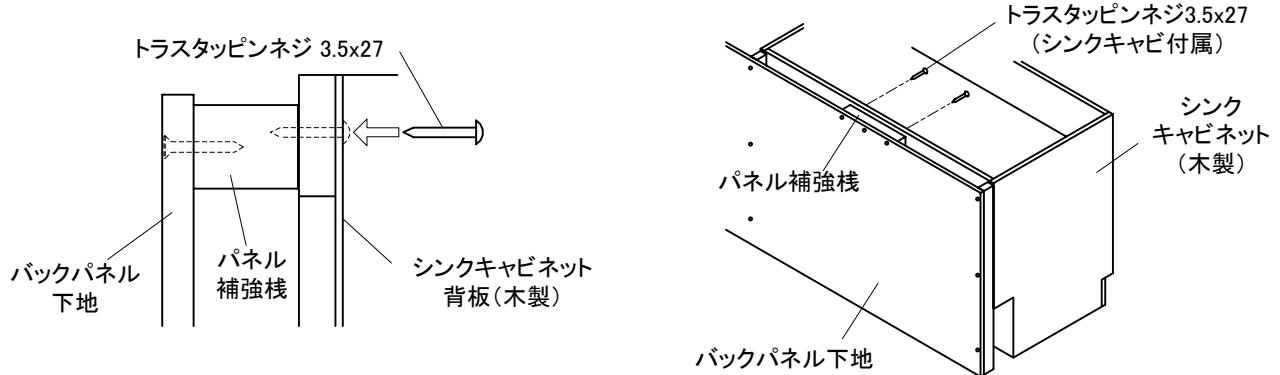
④バックパネル下地の内側を設置基準線Bに合わせて、パネルに取付けたL金具より側壁面・床面にワークトップ付属のネジで固定してください。(20mm角の補強桿が4本同梱されている場合は固定不要)
