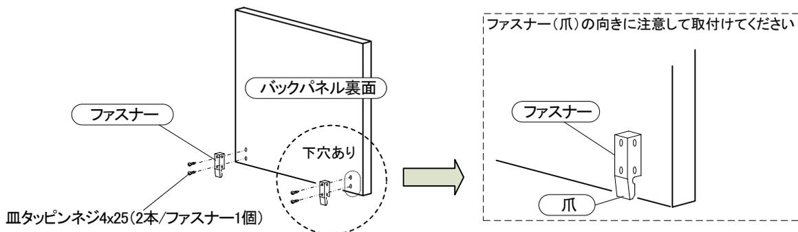
⑦-3 バックパネル裏面に、バックパネル固定板(2箇所、プザイキP-YS-D900、D1045に同梱)および固定金具SNを取付けてください。
