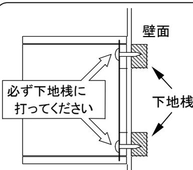
キャビネット固定ネジを打つ部分には、十分な強度をもつ木質の下地棧があることを確認し、所定の付属ネジを使用して、手順通り確実にこなってください。
