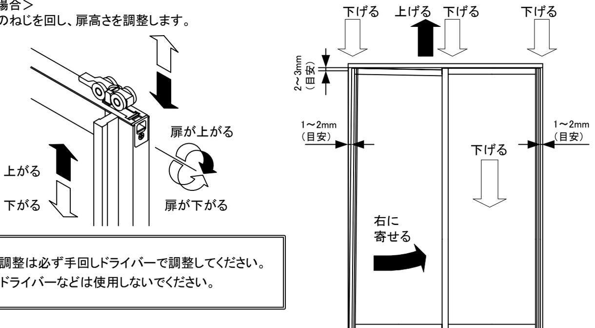
注) 扉の調整は必ず手回しドライバーで調整してください。
