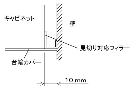
見切り対応フィラー幅を含んだ寸法(+10mm)にカットしてください。
