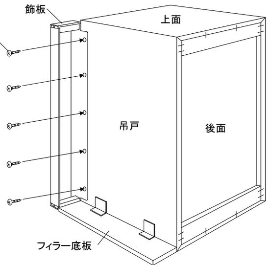
③フィラーの間口が4~14cmの場合は、設置する側壁に金具Bを取付けてください。
