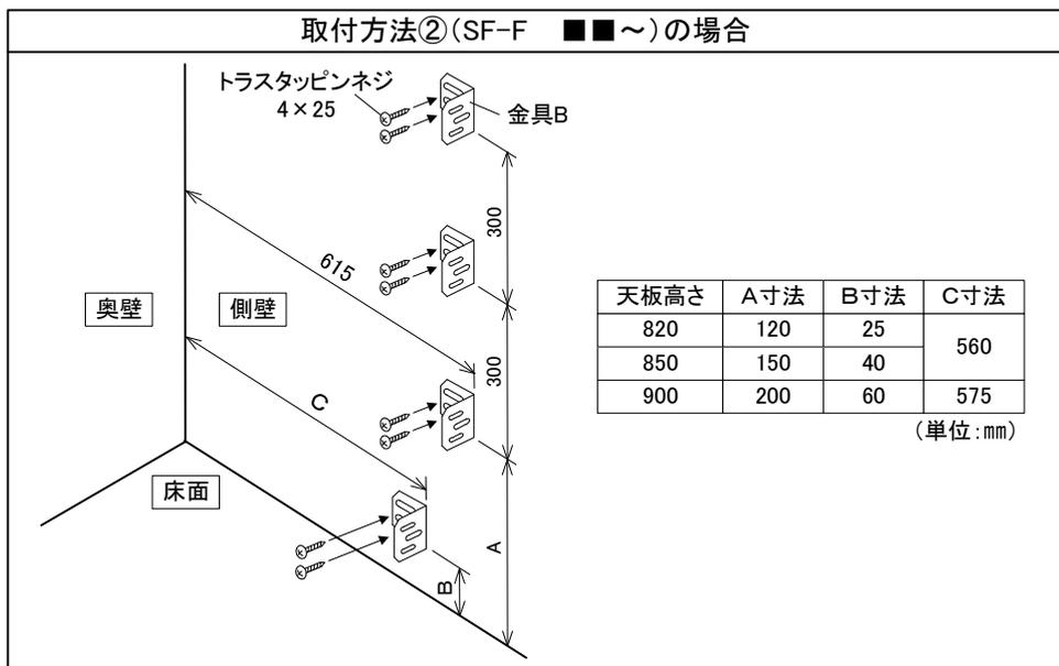
⑥システムキッチンの設置説明書にしたがって、フィラーを取付けたキャビネットを設置してください。
