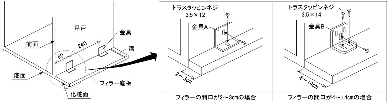
注)・底板フィラーに穴や溝がある場合は、その面が露出しないよう上面に向けて固定してください。
