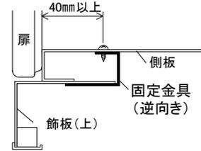
側板の正面から固定金具の穴位置までの長さが40mm以上の場合があります。その場合は、固定金具を逆向きに使用してください。
