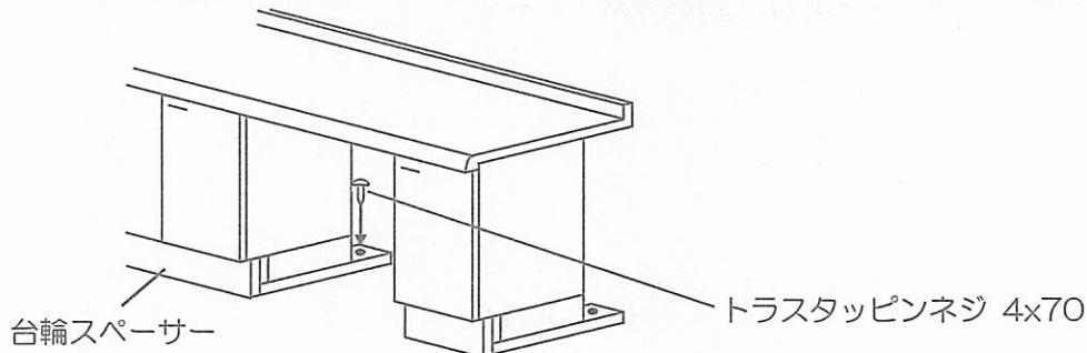
②食器洗い乾燥機用キャビネット（F-DWP 45）の場合は、キャビネットの補強桿を取りはずしてから、台輪スペーサーの穴より、ネジで固定してください。
