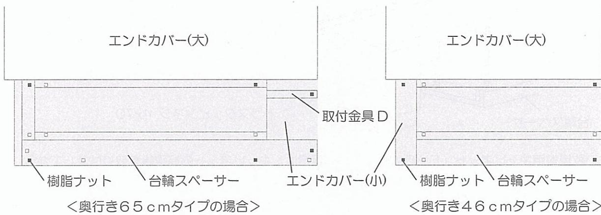
②台輪テープの長さを台輪スペーサー（前スペーサー）の高さ寸法（H）に応じてカットし、キャビネット間の前台輪の継ぎ目をふさぐように貼付けてください。
