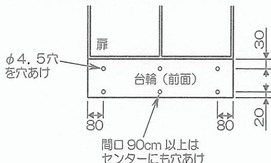
②下桿固定板を所定の長さにカットし、所定の位置に穴を開けてください。
