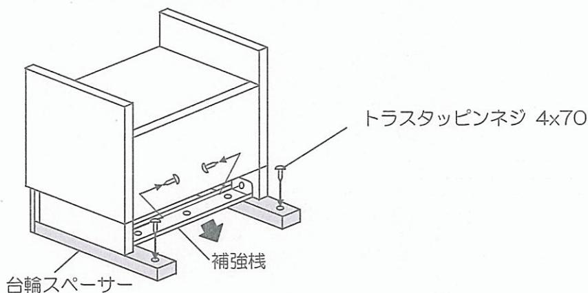
注意) 給・排水配管が床転がしで、台輪スペーサーと干渉する場合は、キャビネットに取付ける前に以下の作業を行ってください。
