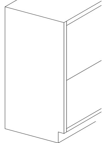
②上部、下部の連結穴よりネジキャップ座金(大)を介してネジで固定し、ネジキャップ(大)を装着してください。
