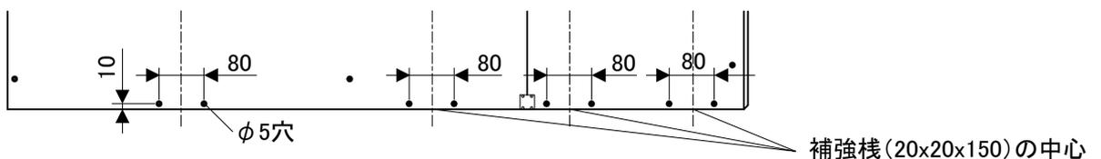
④連結したバックパネル下地に、ワークトップ付属のL金具を下図の位置に取付けてください。
