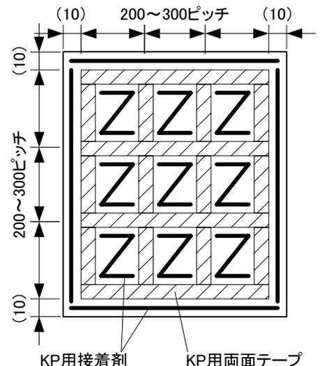
③バックパネル下地表面のほこり等をふき取り、③で貼付した両面テープの離型紙をはがし、下図を参照してパネルをバックパネル下地に貼付けてください。
