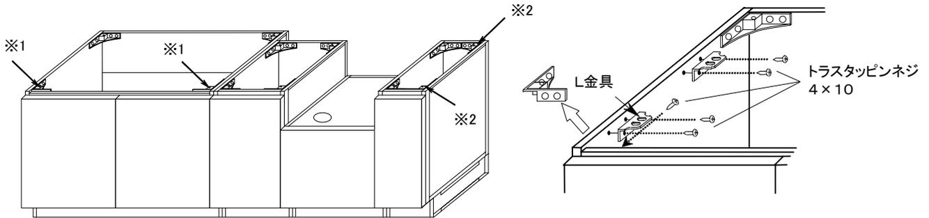
注) 天板固定金具の固定穴は、ダルマ穴になっています。天板固定金具がキャビネット上面より4mm下がるように上側の穴で固定してください。
