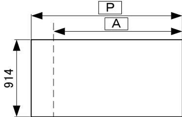
2枚のバックパネルを下記の寸法にカットしてください。
