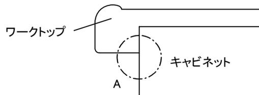
③天板補強棧の取付(コンロと食洗機が隣接する場合のみ)
