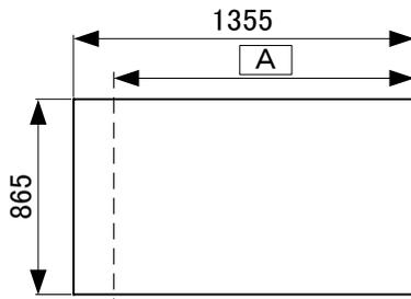
2枚のバックパネルを下記の寸法にカットしてください。
