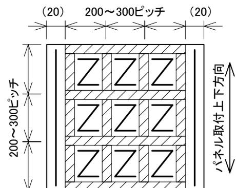
⑥バックパネル下地表面のほこり等をふき取り、④で貼付した両面テープの離型紙をはがし、下図を参照してパネルをバックパネル下地に貼付けてください。
