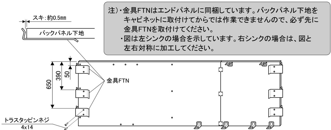
⑥パネル取付棧をバックパネル下地に、ワークトップ付属のネジで固定してください。
