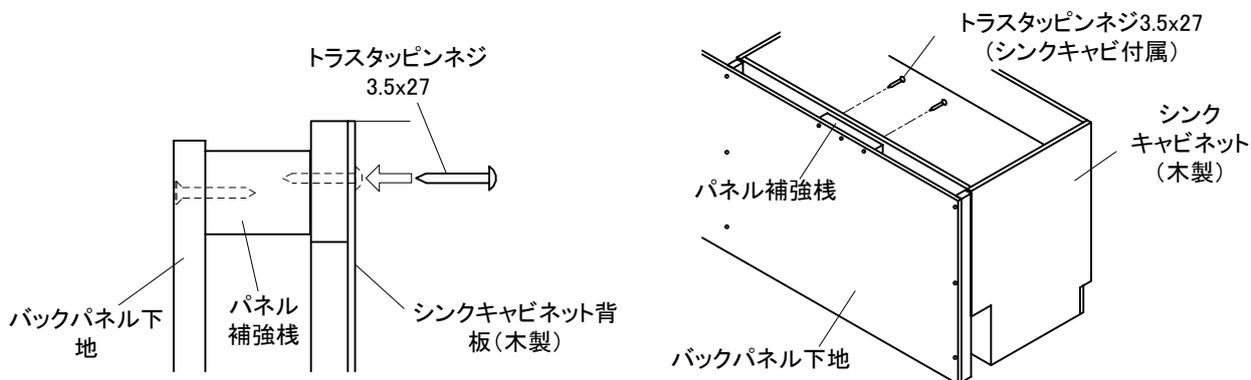
④バックパネル下地の内側を設置基準線Bに合わせて、パネルに取付けたL金具より側壁面・床面にワークトップ付属のネジで固定してください。
