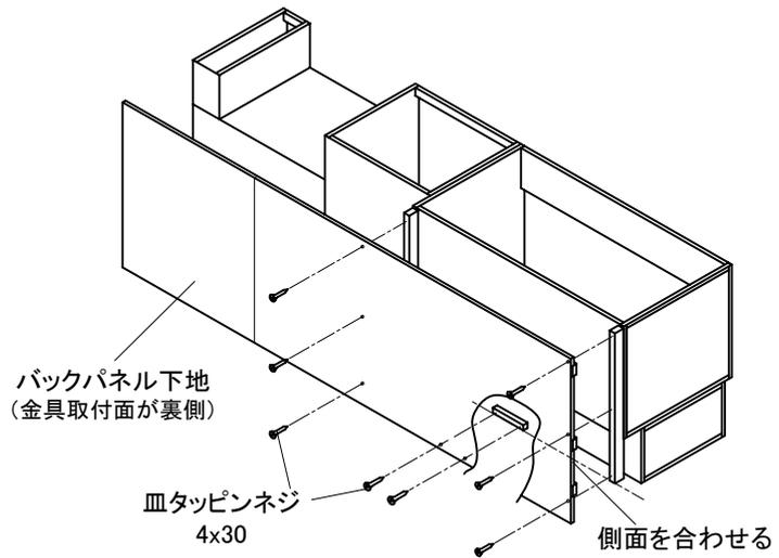
注) ネジ頭がパネル表面より出ないように、あらかじめネジ穴に皿ザグリ加工をしてからネジ打ちしてください。
