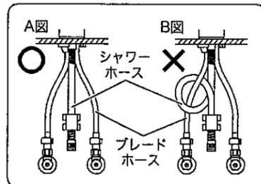
③ 同梱のカプラーユニットにパッキンを入れ、シャワーホースに接続します。その際、シャワーホースをプライヤー等で固定して締め付けてください。本体のプラグにカプラーを押し込む前にカプラーユニットとカプラーとの接続が緩んでいないか確認してください。緩んでいる場合は増し締めしてください。
