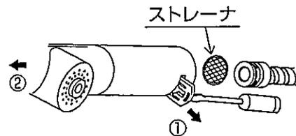
③シャワーフェイスの二面幅に工具をかけ、回して外し、ストレーナ（6個）を取り外す。
