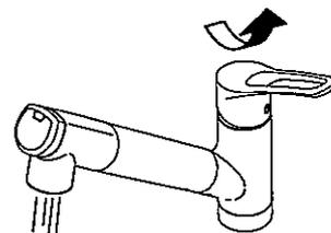
●湯の使用後は、必ずレバーハンドルを水側に戻してしばらく水を流してから止水する。
