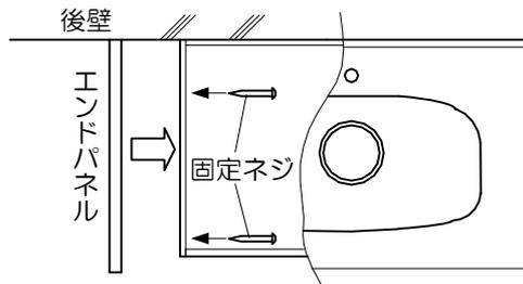
**ご注意** ●エンドパネルの前木口面および上木口面が化粧面となるようにパネルを取付けてください。（トルユニット用は対象外）
