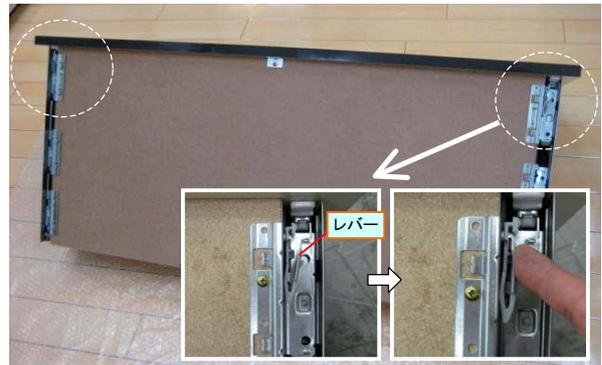
目一杯引き出した状態で、引出裏面にある両側のレバーを押します。
