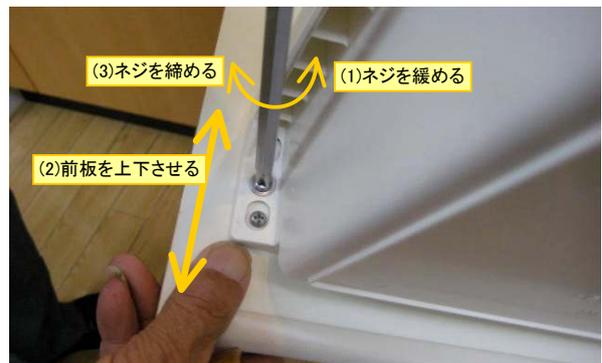
「調整ネジ」を(+)ドライバーで緩めます。前板を上下方向で調整した後、「調整ネジ」をしっかり締めます。
