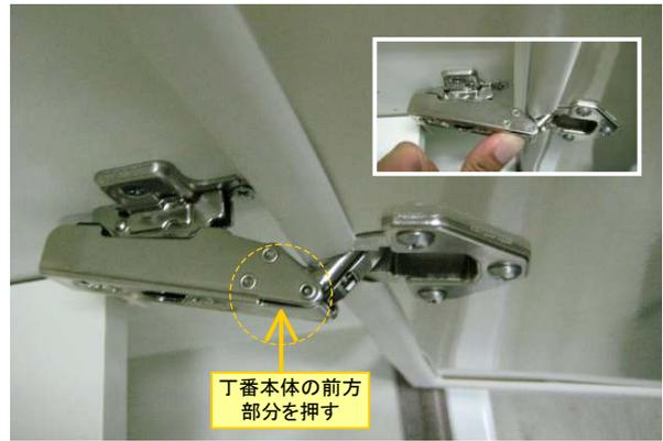
D番本体裏面の取付バーをD番プレートの切り欠き部分に引っ掛けます。
