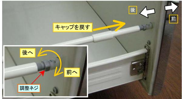
バーの先端に「調整ネジ(グレーの樹脂部品)」があります。
