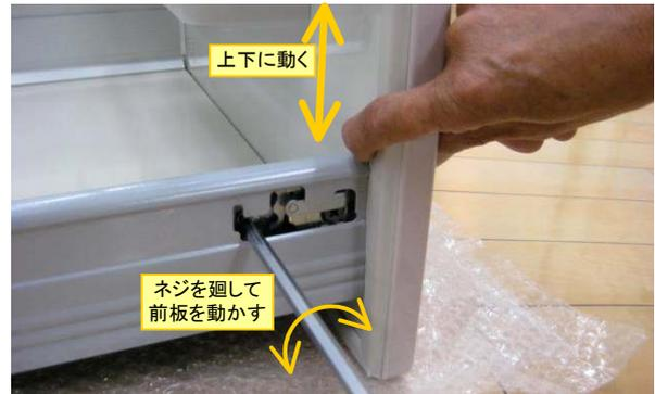
「上下調整ネジ」を(+ )ドライバーで廻すと、前板が上下に動きます。
