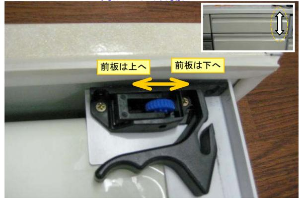
「調整ダイヤル」を外側へ廻せば前板は下へ動きます。
