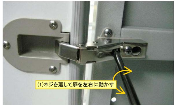
「左右調整ネジ」を(+)ドライバーで左右に廻すと、扉が動きます。
