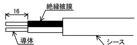
②1次電源のケーブルを、コンセントの裏側の挿入面に直角に奥まで確実に差込んでください。(右図)
