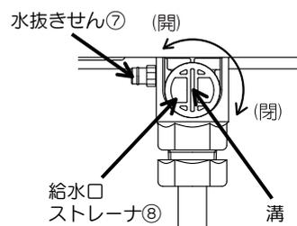
給水口ストレーナ⑧はコインなどを溝に差し入れ右に回して閉じていることを確認します。
