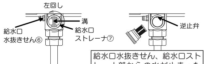
給水口ストレーナ⑦はコインなどを溝に差し入れ左に回して取り外します。
