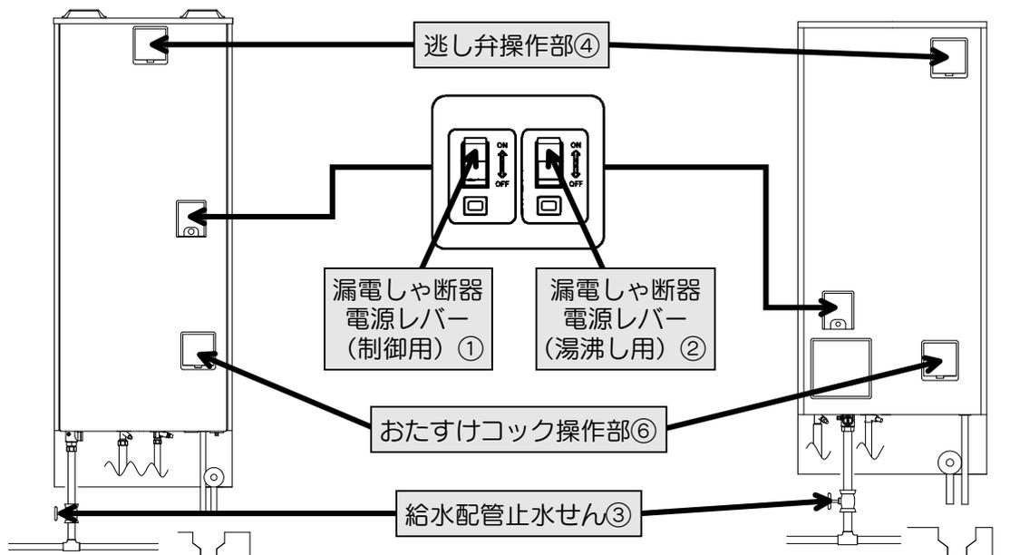
1 漏電しゃ断器電源レバー①②を「切」にします。
