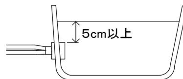
※浴槽が空の状態でも、気温が低くなると循環ポンプが動き出します。
