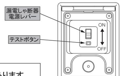
**警告** ■漏電しゃ断器が故障したまま使用すると、漏電時に感電するおそれがあります。
