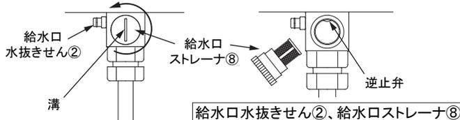
給水口ストレーナ⑧はコインなどを溝に差し入れ左に回して取りはずします。
