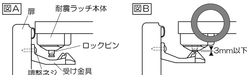
[3] しかし、図Cのように受け金具がラッチ本体に当たってしまう場合は、受け金具を下方にずらす必要があります。金具の調節ネジをゆるめて図Bの位置になるように調節してください。
