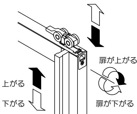
(注) 扉の調整は必ず手回しドライバーで調整してください。電動ドライバーなどは使用しないでください。
