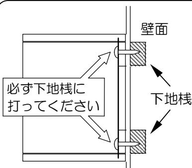
キャビネット固定ネジを打つ部分には、十分な強度をもつ木質の下地桿があることを確認し、所定の付属ネジを使用して、手順通り確実に行ってください。
