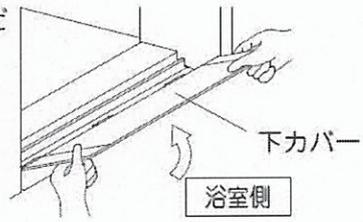
②清掃後は部品④を溝部に差込み、カチッと音がするまで確実に取付けてください。
