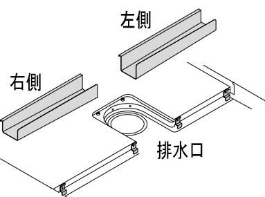
排水樋が排水口の両側にある場合は、排水樋の表示に従い取り付けます。
