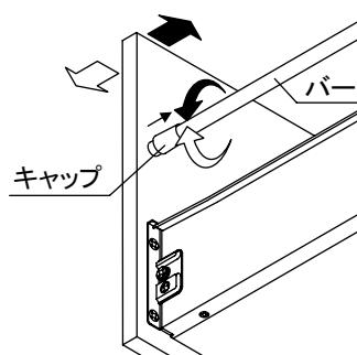
上下・左右調整する場合は、底板下部の金具を止めているネジを緩めてから行う。(調整後、ネジを締めなおす)
