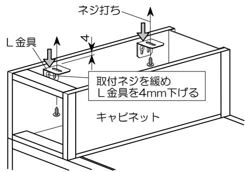
④(木製キャビネットの場合のみ) セット両端のL金具の取付ネジをゆるめてL金具を下方へずらし再度取付ネジを締め込んでください。
