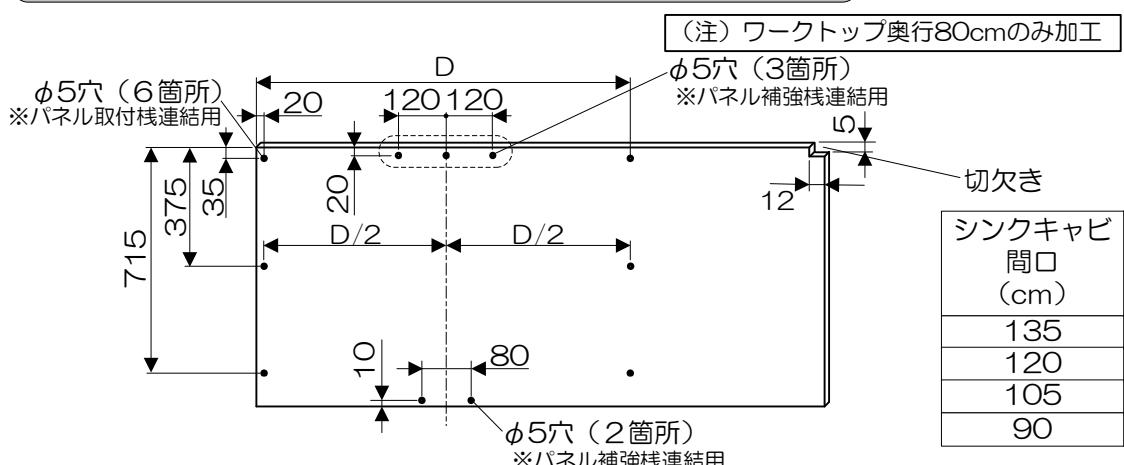
③ バックパネル下地に、ワークトップ付属のL金具を下図の位置に取付けてください。
