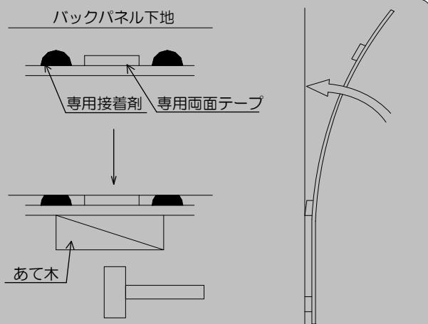
**【9. 木製バックパネルの取付】** (木製バックパネルの場合のみ、ホールー製バックパネルは不要)
