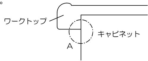
③天板補強桿の取付（コンロと食洗機が隣接する場合のみ）
