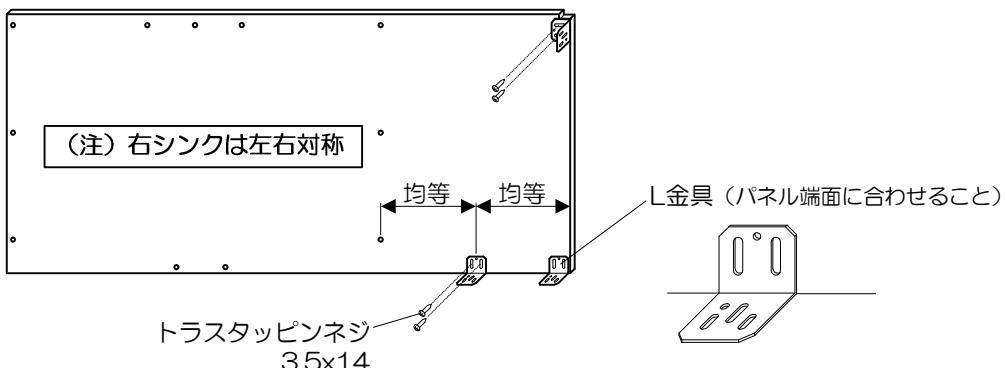
④ (ホーロー扉タイプの場合のみ) 連結したバックパネル下地に、エンドパネル付属の金具FTNを下図の位置に取付けてください。
