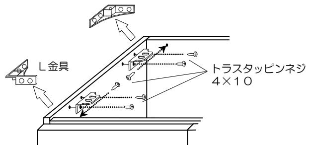
③(ホーロー製キャビネットの場合のみ) 75間口コンロキャビネットがセット端にくる場合は、L金具の取付ネジをゆるめてL金具を4mm下方へずらし再度取付ネジを締め込んでください。
