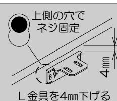
② (ホーロー製キャビネットの場合のみ) 調理キャビネットがセット端にくる場合は、セット端側の隅補強2個（上図※2）をはずして、ワークトップに付属のL金具に付け替えてください。
