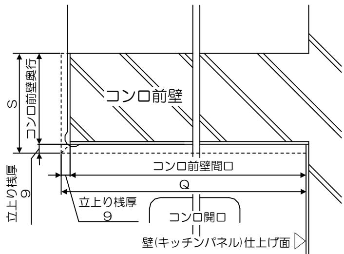
②奥行き方向側の立上り桟のカット面を研磨、R加工して下さい。
