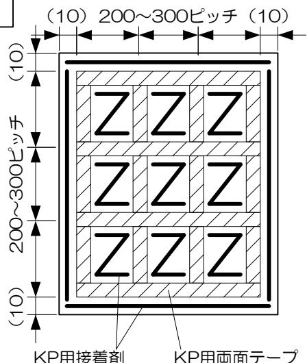
④パネル裏面の所定位置にキッチンパネル用接着剤を塗布してください。
