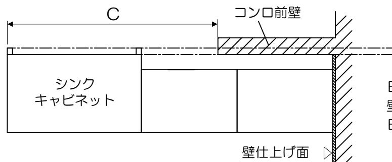
B寸法はシンクキャビネット端からコンロ前壁までの寸法より1mm短くしてください。
