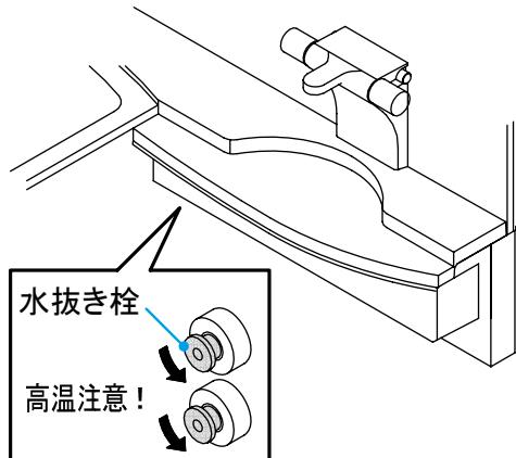
※給水給湯の配管方法により水抜き栓がない場合があります。
