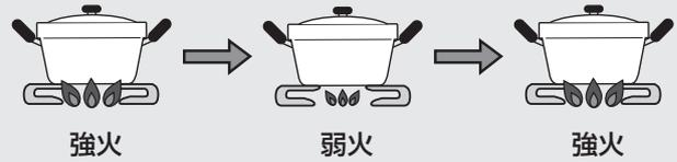
●から焼きなどでなべの温度が急速に上昇すると、安全のため加熱途中でも火力をいったん弱くし、異常高温に達しないよう火力を自動制御します。
