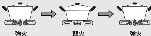
●から焼きなどでなべの温度が急速に上昇すると、安全のため加熱中でも火力をいったん弱くし、異常高温に達しないよう火力を自動制御します。
