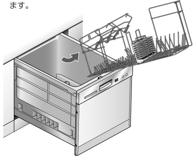
②回転ノズル・タワーノズルをはずします。
