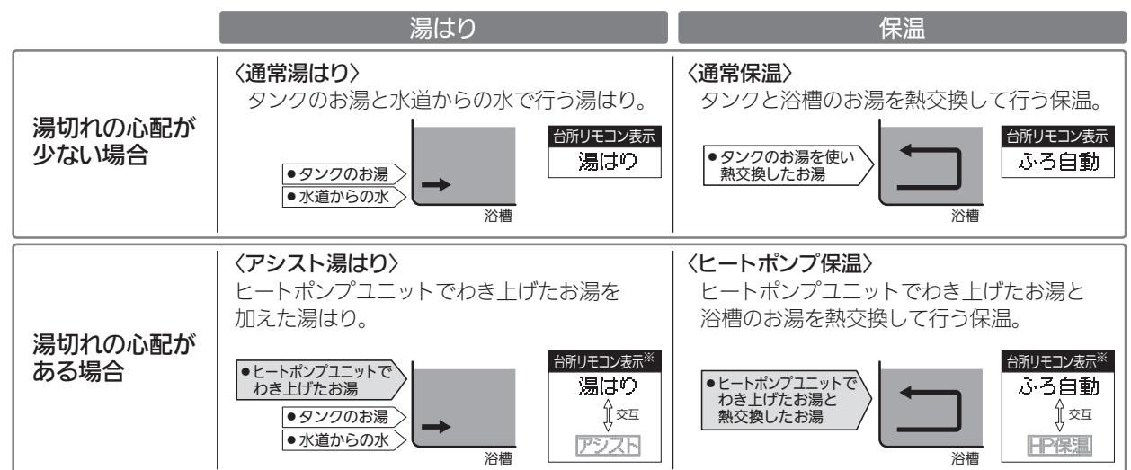
※浴室リモコンは、ヒートポンプユニット動作時に「アシスト湯はり」「ヒートポンプ保温」と表示されます。
