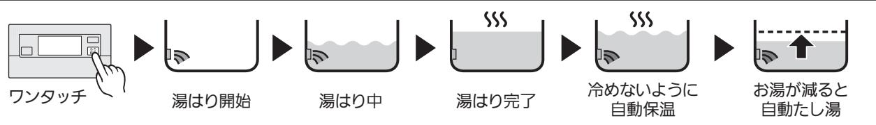
湯はり完了後、設定された時間の間、おふろの温度とお湯の量を保つ運転(「自動保温」、「自動たし湯」)がはたらきます。
