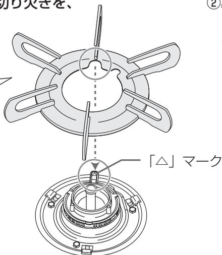
②裏面の突起（3か所）をトッププレートの差し込み穴にはまるようにセットする
