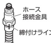
②クイックファスナーをシャワー側接続部とホース接続金具のツバ部に確実にめ込んでください。次に抜け止めカバーをクイックファスナーに確実にめ込んでください。
