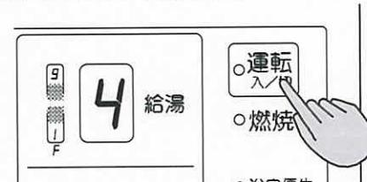
■メインリモコンの給湯温度表示部に「8」が点滅しているときは、空だきサーモスタットが作動しています。
