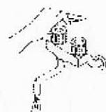
④ 給湯栓を閉じると自動的に消火します。
