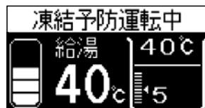
浴槽が空の状態でも、気温が下がると循環ポンプが動き出します。循環できない場合、循環ポンプは約2分後に停止しますが、その間、ふろ配管の残水が浴槽へ流れ込みます。
