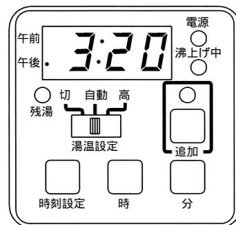
追加湯沸し動作ランプが点灯し、5秒後に動作を開始します。
