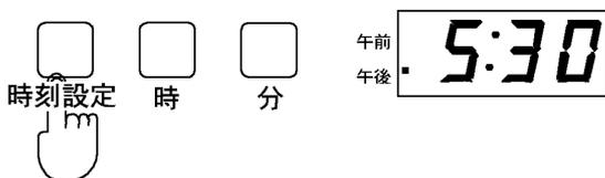
時刻設定スイッチを再び押さなくても、時・分スイッチを1分以上操作しないと、自動的に時刻を確定し、点滅が止まります。
