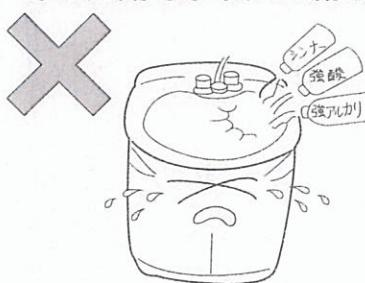
●ボウル表面が変色したり、排水パイプが損傷して、水漏れ事故が発生するおそれがあります。
