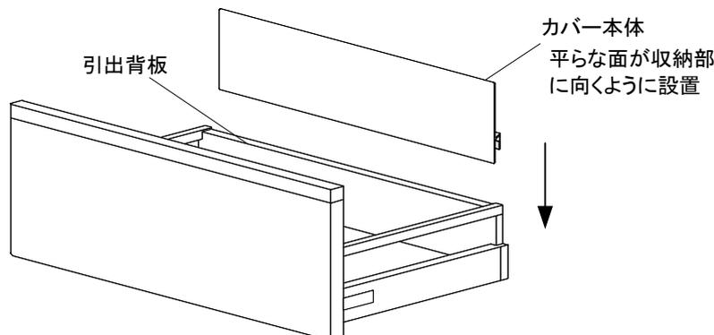
②カバー本体と引出背板の間に留め具を「カチッ」と音が鳴るまで差し込み、カバー本体を固定します。
