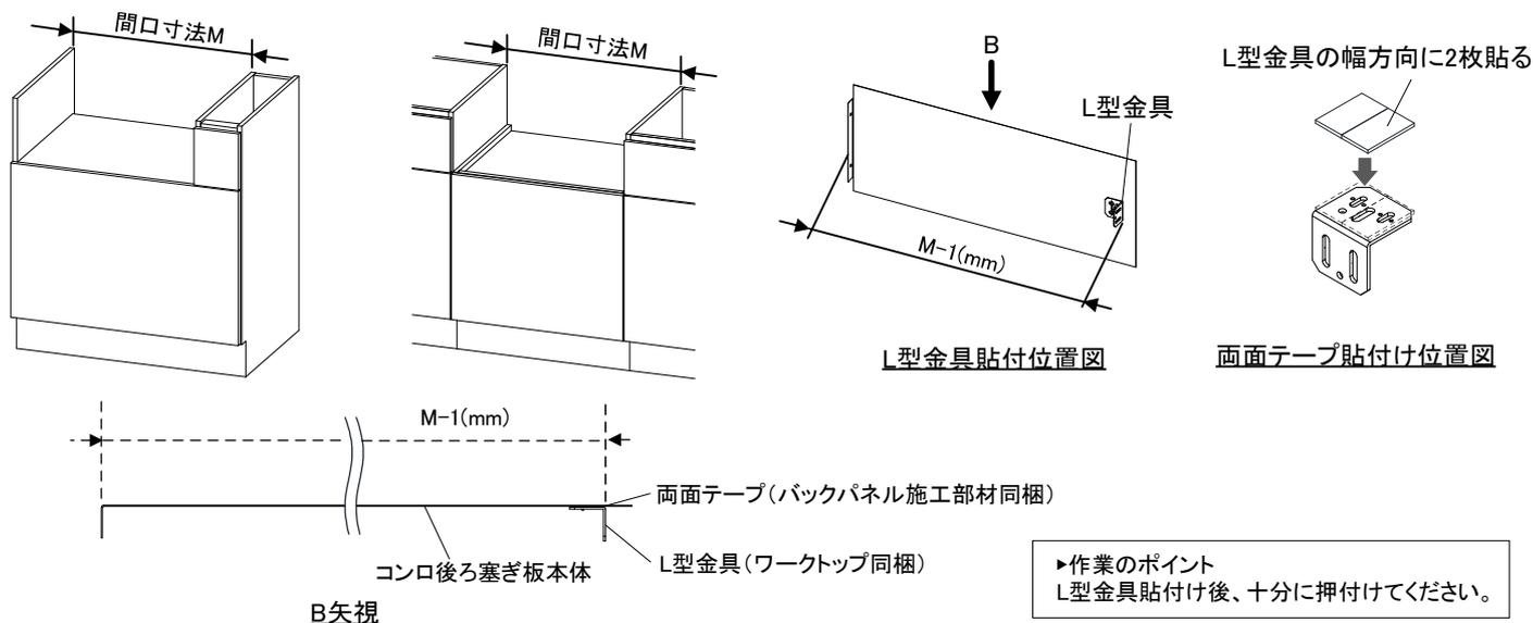
②ワークトップのコンロ開口からコンロ後ろ塞ぎ板本体を挿入してください。
