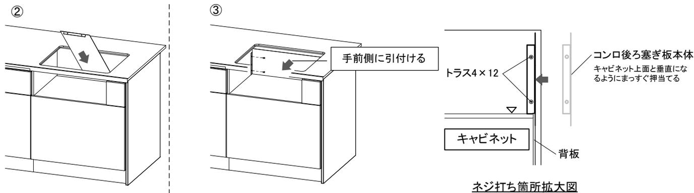
④手前側に引付けながら、反対方向の側板にL型金具をネジ固定してください。
